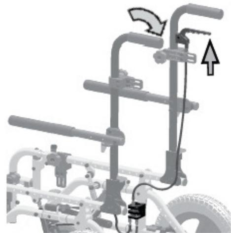
Uno dei due antiribaltamento è dotato di una leva da utilizzare come aiuto per il superamento degli ostacoli. Per ottenere questa funzione è sufficiente ruotare l'antiribaltamento verso l'alto
