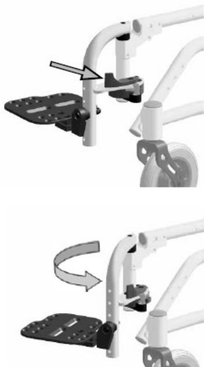
La NXT è dotata di pedane separate swing away (con tubolare a 70° o 90°) e removibili.
